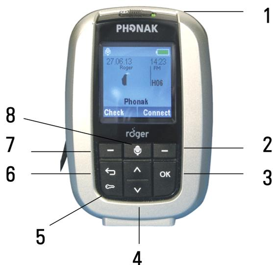
**Hinweis: Im Folgenden werden nur noch die Pfade angegeben: Menü → Unterpunkt → Unterpunkt. Mit den Pfeiltasten kann der jeweilige Unterpunkt angesteuert und mit der OK-Taste ausgewählt werden. Mittels Taste 6 kann der Unterpunkt bzw. das Menü verlassen werden.**
